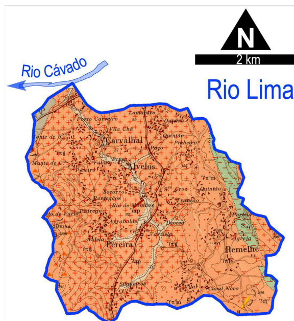
FIG. 63 – Fundo geológico para a bacia de drenagem do Rio Lima – domínio claro das rochas graníticas (cor vermelha) em detrimento das rochas metassedimentares (cor verde)
