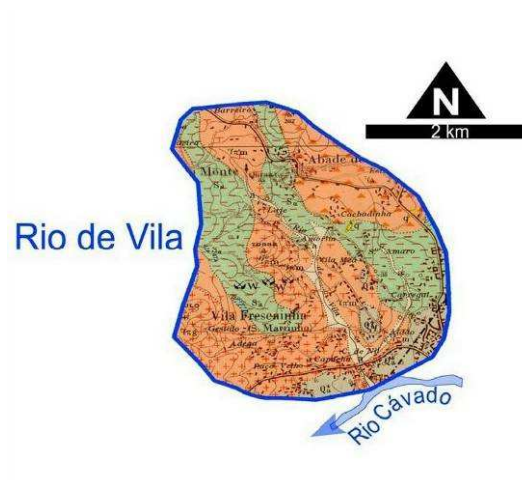
FIG. 60 – Fundo geológico para a bacia de drenagem do Rio de Vila – verifica-se algum equilíbrio entre as rochas graníticas (cor vermelha) e as rochas metassedimentares (cor verde)
