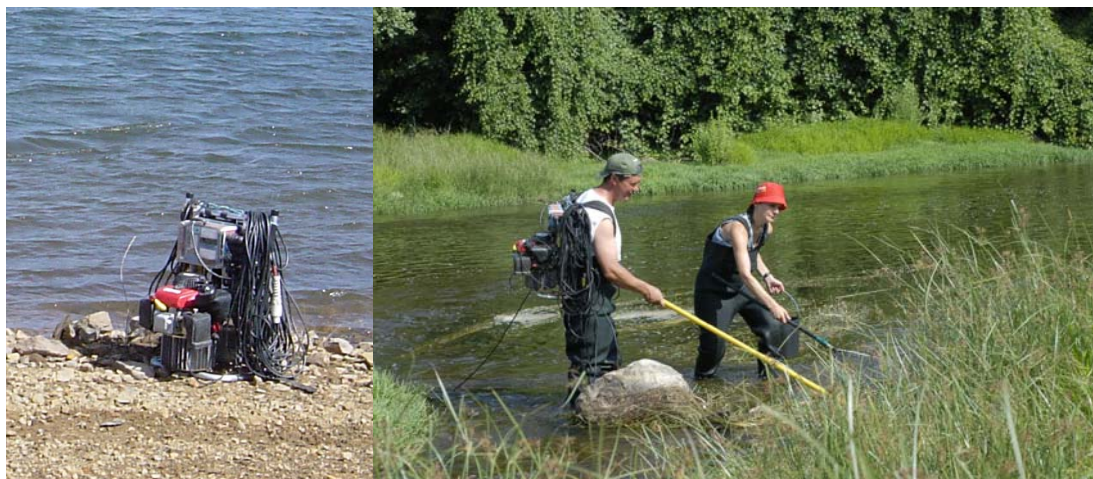
Figura 4.7.9 – a) Equipamento de pesca eléctrica usado para a captura das comunidades piscícolas, b) Captura das comunidades piscícolas por pesca eléctrica.
